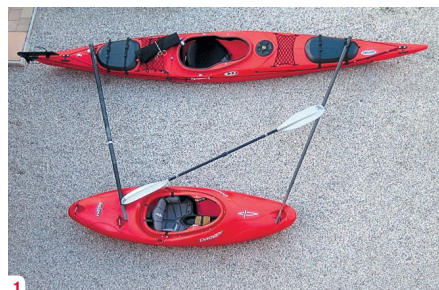
1: Osnutek katamaranske konstrukcije v naravni velikosti. Iskanje kompromisa med veslanjem in možnostjo jadrnanja. 2: Katamaran, ki omogoča neovirano veslanje in jadrnanje, je pripravljen za testno plovo.
