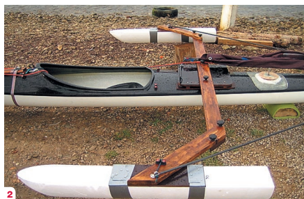
1: Katamaran na preizkušnji v močni burji, ki je ob sunkih med jadrnanjem začela nevarno dvigovati stranski plovec. Zato je bil nadaljnji razvoj preusmerjen v trimaransko izvedbo. 2,3: Osnutek in končna izvedba trimaranske konstrukcije. Težava je bila izdelati povezavo stranskih plovcev s centralnim trupom, ki ne sme ovirati veslanja. Tudi zložljivo jadro je bilo treba povsem spremeniti in sistem zlaganja prilagoditi trimaranski izvedbi – izdelani sistem postavljanja in zlaganja jadra je ključna patentno zaščitena inovacija.
