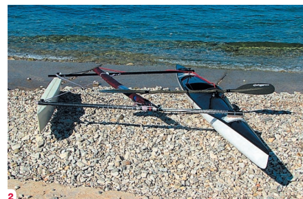
1: Osnutek katamaranske konstrukcije v naravni velikosti. Iskanje kompromisa med veslanjem in možnostjo jadrnanja. 2: Katamaran, ki omogoča neovirano veslanje in jadrnanje, je pripravljen za testno plovo.
