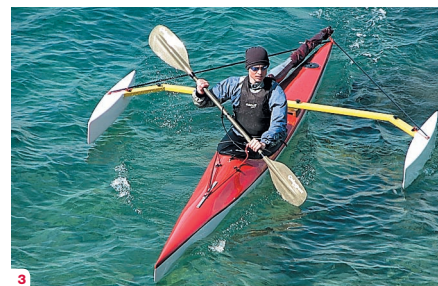
1: Katamaran na preizkušnji v močni burji, ki je ob sunkih med jadrnanjem začela nevarno dvigovati stranski plovec. Zato je bil nadaljnji razvoj preusmerjen v trimaransko izvedbo. 2,3: Osnutek in končna izvedba trimaranske konstrukcije. Težava je bila izdelati povezavo stranskih plovcev s centralnim trupom, ki ne sme ovirati veslanja. Tudi zložljivo jadro je bilo treba povsem spremeniti in sistem zlaganja prilagoditi trimaranski izvedbi – izdelani sistem postavljanja in zlaganja jadra je ključna patentno zaščitena inovacija.
