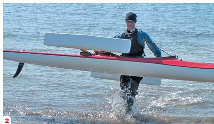
1: Jadranje na Bohinjskem jezeru. 2,3: Ker celotno plovilo tehta le 25 kg, transport in prenašanje ne predstavljata velike težave. V razstavljeni obliki je plovilo preprosto za transport z osebnim vozilom.
